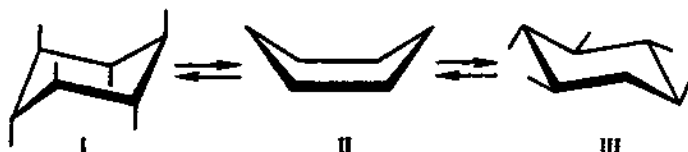
Рис. 53. Конформационные модели молекул циклогексана: I, III — конформация «кресла», II — конформация «ванны»
