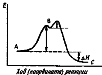
Рис. 59. Схема изменения энергии в реакционной системе при электрофильном замещении:
